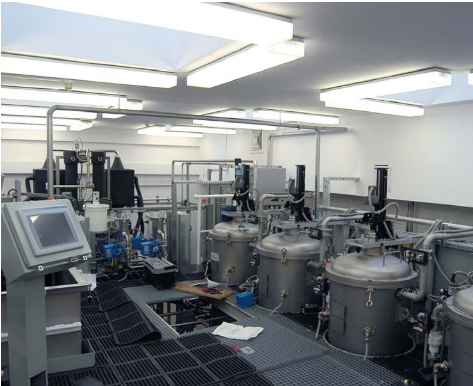
Linia technologiczna Bookkeeper do odkwaszania książek
