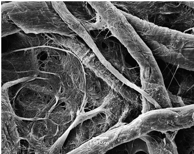
Fot. 7. Czysta bibuła Whatman jest materiałem o dużej mikroporowatości. Widoczne są włókna roślinne poddane procesowi fibrylacji podczas produkcji. Obraz SEM-SE
